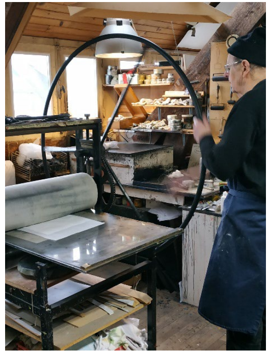
Passage en presse de la matrice afin d'obtenir le tirage Musée des Beaux-Arts de Quimper © Droits réservés
